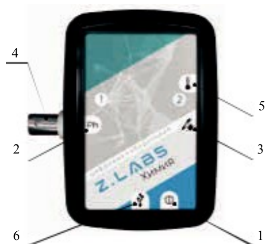
Рисунок 4.2.1 Беспроводной мультидатчик по химическому мониторингу: – сенсорная кнопка вкл./выкл. мультидатчика; 2 – разъем для подключения измерительного электрода датчика pH; 3 – разъем для подключения датчика электропроводности; 4 – гнезда для подключения датчика высокой температуры (термопары); 5 – разъем для подключения платинового датчика температуры; 6 – USB разъем для зарядки АКБ и подключения к ПК
